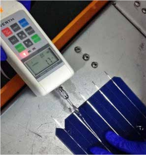
Şekil 3.4. Hücre-Ribbon Çekme (Peeling) Testi
