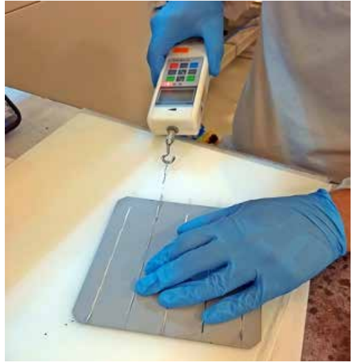
Şekil 3.4. Hücre-Ribbon Çekme (Peeling) Testi
