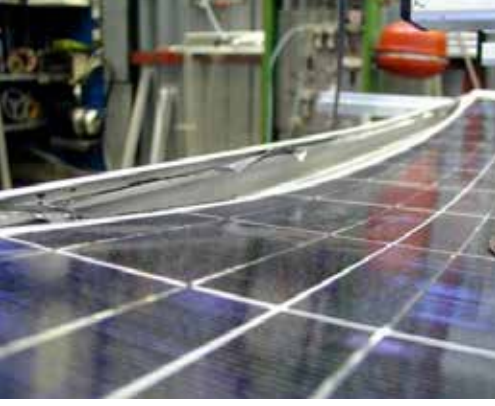
Şekil 3.1. Mekanik yük testi
