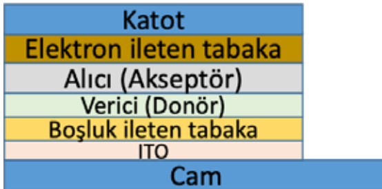
Şekil 2.12 Çift katmanlı (bilayer) güneş gözesi yapısı.
