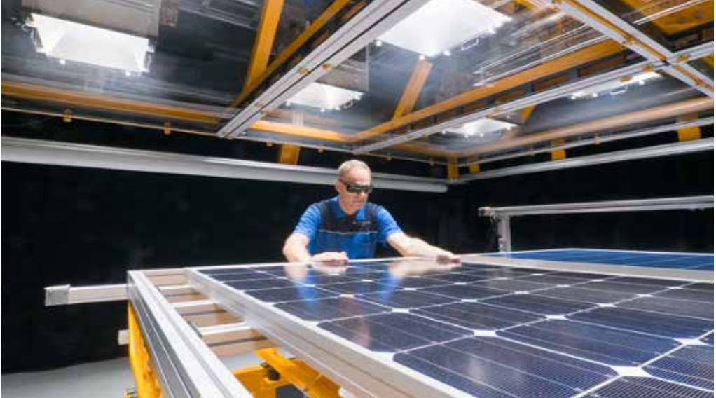
Şekil 3.11. Güç Ölçümü testi
