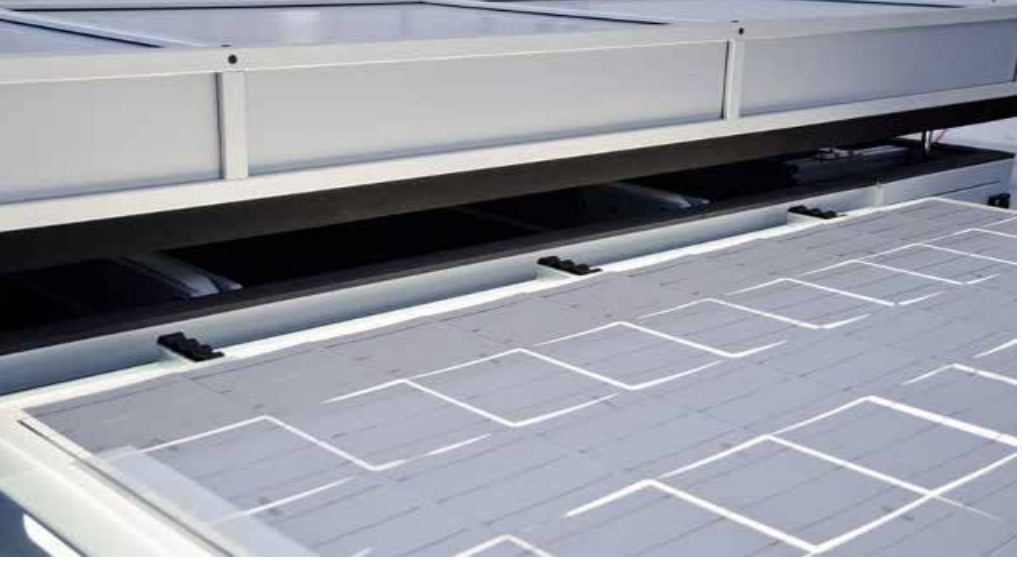
Şekil 3.8. Laminasyon öncesi Elektrolüminesans kontrol
