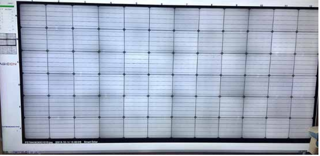
Şekil 3.12. Paketleme öncesi yapılan elektrolüminesans test sonucu elde edilen görüntü
