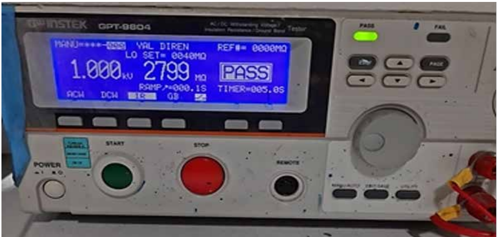
Şekil 3.10. Toprak Süreklilik, İzolasyon ve Yüksek Voltaj Testi
